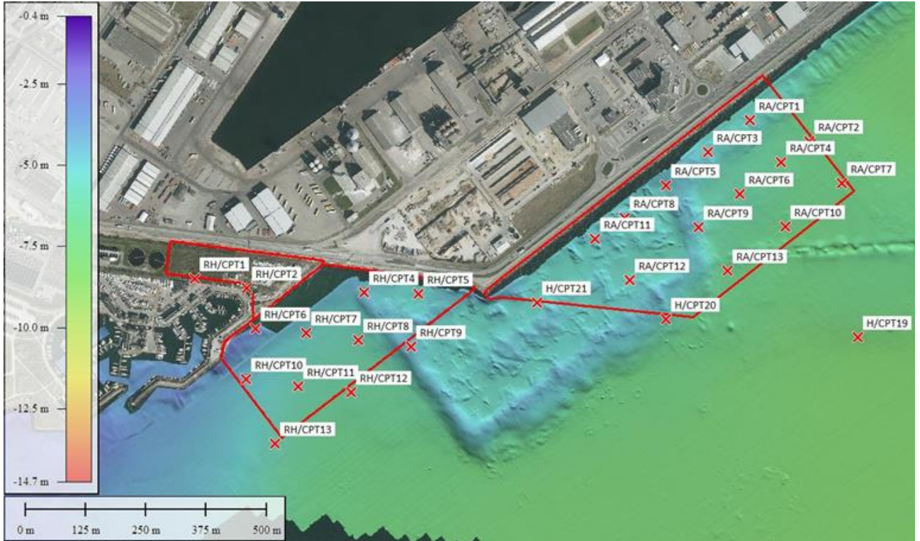
Figur 3-10 Situationsplan visende geotekniske borer, CPT forsøg og havbundsni- veau (fra geofysiske undersøgelser, 2018) i meter DVR90, samt områdef- grænsninger for henholdsvis Hovedforslag og Alternativ 2.
