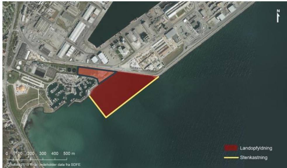
Figur 3-4 Placering af Hovedforslag for Aarhus ReWater. Landopfyldning er angivet med rødt og kystindfatning (stenkastning) med gult. Det eksisterende landområde, der indgår som en del af Aarhus ReWater, er angivet med en lysere rød farve.
